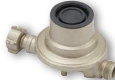
P10087 001854AE Détendeur simple, débit 4kg/h, pression d'entrée 2 à 16 bars, pression de sortie 37 mbars, raccord diamètre entrée écrou bouteille, sortie m20x1,5- raccords rc-flb flexibles, utilisation artisanale ou industrielle pce
